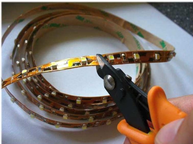
Pásek lze zkrátit či nastavit pouze v místě k tomu určeném, tzn. mezi jednotlivými moduly. Viz. Obrázek níže - v prvním případě lze přestříhnout přesně mezi pájecími body, v druhém se musí rozletovat (rozpájet). Maximální teplota při rozletování je 270°C až 310°C., při vyšších teplotách může dojít k poškození LED pásku.
