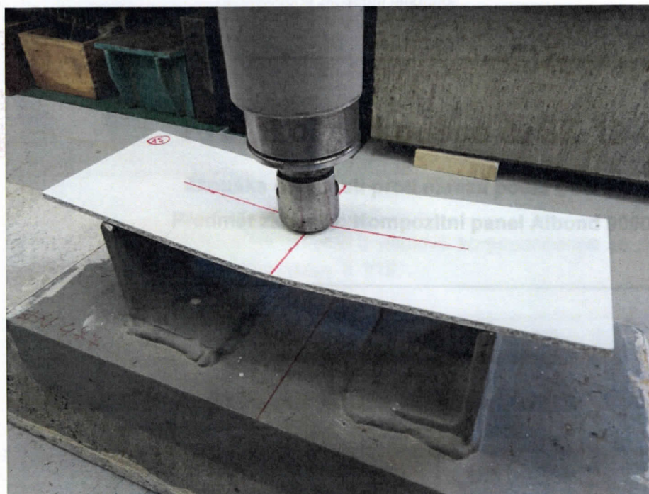
Obr.č.1 – Zkouška rázem – zkušební zařízení
